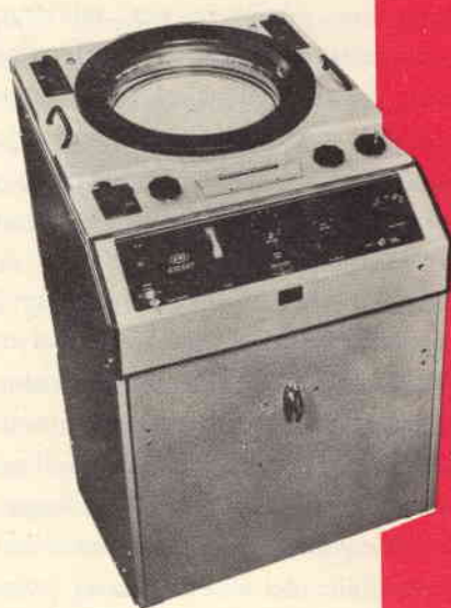
Il radar Escort tipo 604, costruito dalla Associated Electrical Industries Ltd., ha un tubo da 16 pollici e comprende una calcolatrice che riduce al minimo le regolazioni manuali.
