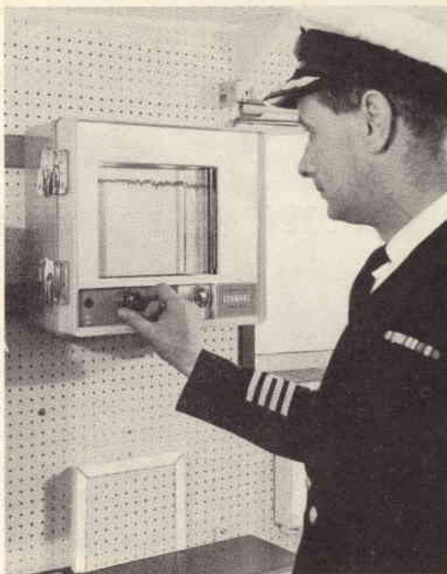
L'ecometro Seamarc della Marconi, in cui sono impiegati soltanto transistori, ha un'alta definizione e si può usare per la localizzazione dei pesci.
